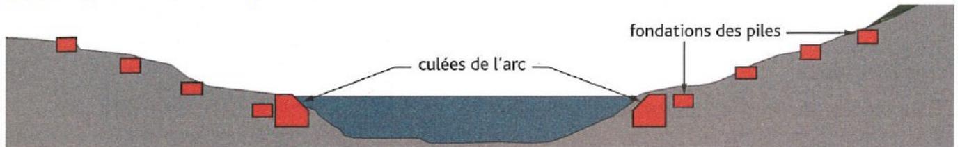
Mars – Septembre 1993 : Coulage des culées en béton qui serviront d'appui pour l'arc et début des fondations des piles sur les deux rives. Fabrication des 55 voussoirs (éléments de l'arche : 2 x 27 et une clé de voûte) qui seront assemblés sur place comme un jeu de construction.
